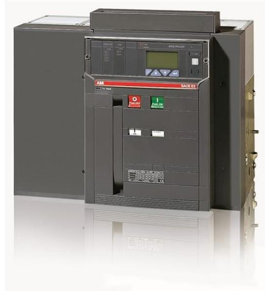
Итальянское sace EMAX выключателя e3s успешно 1250A четыре полюса закреплены с задней горизонтальной расцепитель PR122/П-ли R1250 оснащена: 4 вспомогательный контакт и С. выключатель в положение открыто-закрыто
