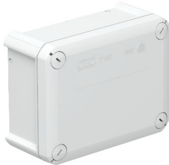
As caixas de derivação são feitas de um termoplástico polipropileno, polímero fechado com paredes laterais. Isso significa que as aberturas podem ser feitas para onde eles são necessários. EDK plug-in de selos ou cabo de glândulas com porcas podem ser inseridos nessas aberturas, para permitir a inserção do cabo.
