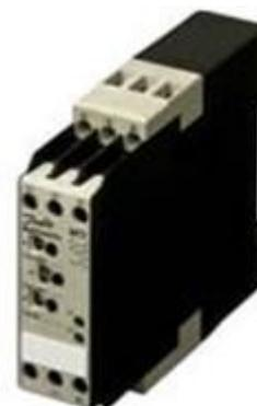
Os temporizadores eletrônicos com seu design robusto e muitas funções integradas são ideais para montadores de painéis e OEMs. Fácil ajuste de tempo Imunidade a ruído elétrico Resistência a vibração e choque mecânico Intervalos de tempo: 0,05 s a 300 h Dimensões compactas padrão Montagem com adaptador ou trilho DIN Recursos: Atraso ao ligar ( On) Atraso ao desligar (Off) Pausa de pulso único ou pausa de pulso Pausa de pulso intermitente ou pausa de pulso Partida estrela-triângulo
