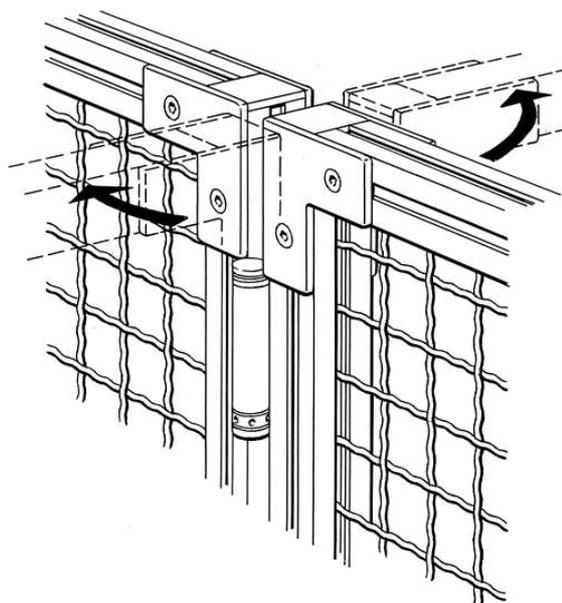
Duas vias de dobradiça. O aço revestido com zinco. A fresta da porta serão de 28mm, quando instalado
