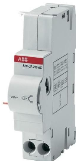
O S2C-UA 12 DC subtensão tem a função de proteger a carga em caso de uma queda de tensão entre 70% e 35% do seu valor nominal. Segurança positiva (o dispositivo de disparo quando a tensão é desligada) para de emergência por meio de um botão. Adequado para MCBs S200 série, RCCBs F200 série e Kbl DS201, DS202C, DS200 série. Ele pode ser usado com MCBs SN201 série por meio de SN201-IH módulo de interface. Tensão nominal: 12V d.c.
