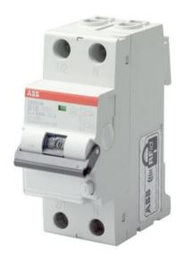
O DS201 série RCBO é um 1P+N em dois módulos dispositivo para a proteção do usuário final de fase única de circuitos contra sobrecarga e correntes de curtocircuito; proteção contra os efeitos do senoidal alternada e direta pulsante terra, as correntes de falta; a proteção contra contatos indiretos e adicionais de proteção contra contatos diretos (com sensibilidade = 30 mA).
