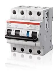
DS203NC é uma 3P+N disjuntor de corrente com proteção de sobrecorrente (RCBO) em quatro módulos para a proteção contra correntes de curto-circuito, sobrecarga, falha de terra correntes, contatos indiretos, adicionais de proteção contra contatos diretos (30 mA versões).
