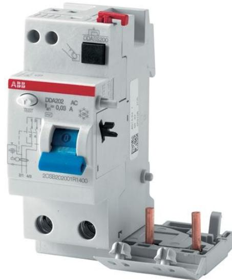
O bloco de RCD DDA200 série é adequado para a montagem com MCBs S200 série. Ele assegura a proteção contra os efeitos do senoidal alternada e direta pulsante terra, as correntes de falta, proteção contra indirects contatos e proteção adicional contra direta (com sensibilidade = 30 mA) contatos. Aplicações: residencial, comercial, industrial.
