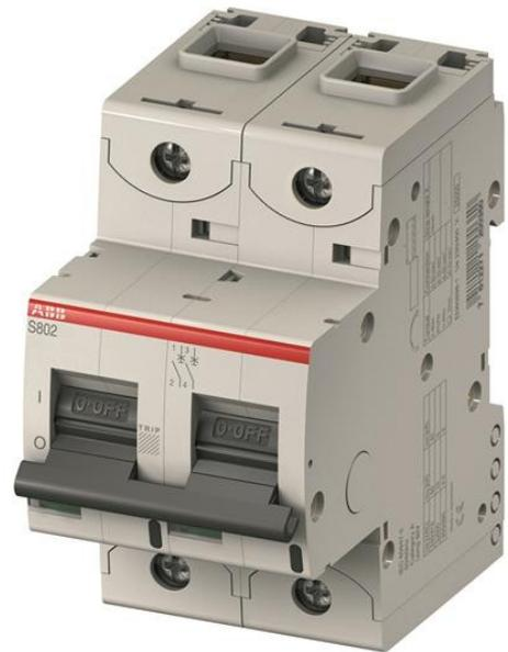
O S802PV-M100-H é um 2-pólo polarizada separadora para a energia fotovoltaica. Ele pode ser usado para correntes de até 10A e tem uma tensão nominal de operação de 1000V DC por apenas 54 mm de largura. Nominal de curto prazo corrente de resistência lcw é de 1,5 kA. O S802PV-M100-H está em conformidade com a norma IEC/EN 60947-3. Possui um grande número de aprovações, portanto, ele pode ser usado em todo o mundo. A extensa gama de acessórios torna o uso de S802PV-M100-H mais confortável.
