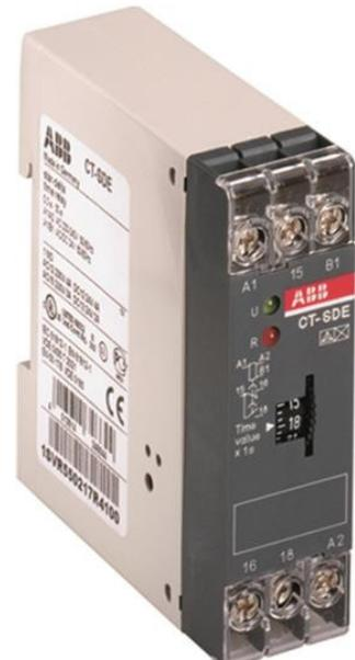
O CT-SDE é uma única função de relé de tempo eletrônico do CT-E temporizador de intervalo. Ele fornece uma estrela-delta função com um intervalo de tempo de 0,3 s para 30 s. Desta vez relé opera com uma taxa de controle de tensão de alimentação de 110 - 130 V AC e tem um 1 n/s + 1 n/c de saída com contatos avaliado em 250 V / 4 A.
