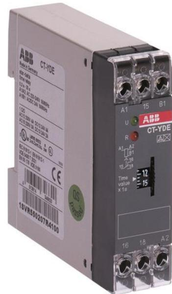
O CT-YDE é uma única função de relé de tempo eletrônico do CT-E temporizador de intervalo. Ele fornece uma estrela-delta função com um intervalo de tempo de 0,1 s para 10 s. Desta vez relé opera com uma taxa de controle de tensão de alimentação de 110 - 130 V AC e tem um 1/c (SPDT) saída nominal: 250 V / 4 A.
