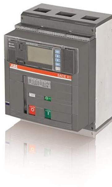
C. DISJUNTOR EMAX X1N 1250 FIXO de TRÊS polos COM FRENTE TERMINAIS E de ESTADO SÓLIDO de LANÇAMENTO NO AC PR332/P-LSI R 1250 EQUIPADO COM: 4 de contatos AUXILIARES E C. DISJUNTOR NA POSIÇÃO de ABERTO-FECHADO
