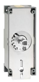
A operação de ambos a chave de aterramento e o interruptor-seccionador / disjuntor em Onposition, ao mesmo tempo, é mecanicamente evitados usando dois cabos entre a chave de aterramento e a principal chave ou um disjuntor. Comprimento do cabo de 1370 mm.
