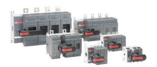
Incluindo um preto ON-OFF com cabo de plástico e veio como padrão. O eixo é ajustável para uma gama de montagem em profundidade. O identificador é IP65 protegido, Nema tipo 1, 3R, 12, trava com cadeado FORA de posição e com intertravamento da porta na posição. Montagem do eixo da profundidade medida a partir do lado esquerdo da chave, de 3 pólos: H=154...166mm e 4 pólos: H=189...201mm. Fusível normas UL 248.
