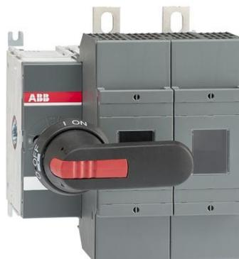
Incluindo o terminal de parafuso kit, um preto ON-OFF com cabo de plástico e veio como padrão. O identificador é IP65, NEMA 1, 3R, 12 protegido, trava com cadeado FORA de posição e com intertravamento da porta na posição. O eixo é ajustável para um intervalo de profundidade da instalação. Fusível normas UL 248.
