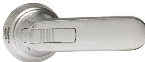
Aço inox, a indicação I-O/EM-OFF, trava com cadeado com 3 cadeados na posição de intertravamento da porta na posição, grau de proteção IP66 (NEMA 4X), cinza.
