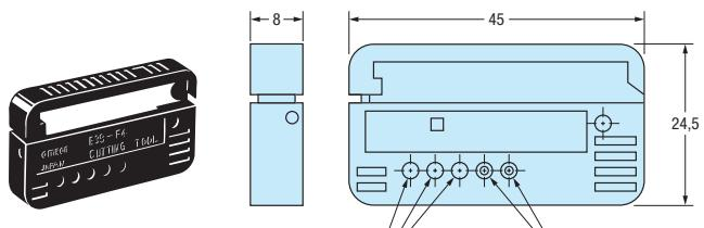
Материал: корпус: алюминий; линза: оптическое стекло
