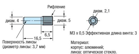
Материал: корпус: алюминий; линза: оптическое стекло.
