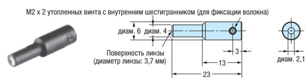
Материал: корпус: алюминий; линза: оптическое стекло
