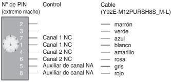
Nota: Si el circuito auxiliar no se ha colocado o no está siendo utilizado, corte y deseche los conductores amarillo/verde o gris/rojo.
