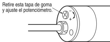
La distancia de detección aumenta girando el potenciómetro en el sentido horario y disminuye girando el potenciómetro en el sentido antihorario. El potenciómetro puede hacer  $15 \pm 3$  vueltas válidas y, a continuación, hacer vueltas en vano porque no tiene tope. Sin embargo, dichas vueltas no lo dañan.
