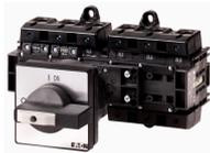
Interrupteur général, 6 pôle + 1 Contact F + 1 Contact O, 160 A, Fonction d'arrêt, 90 °, verrouillable en position 0, Encastrement / Montage encastré avec fixation arrière
