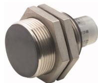
Näherungsschalter, induktiv, 1Ö, S<sub>n</sub>=10mm, 3L, 6-48VDC, NPN, M30, Metall, M12
