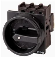
**Interrupteur général, tripolaire + 1 Contact F + 1 Contact O, 32 A, Fonction d'arrêt, verrouillable en position 0, Montage encastré**
