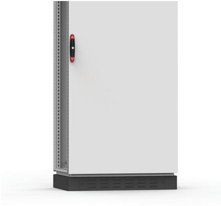
: Фронтальные и тыловые секции цоколя с вентиляруемыми панелями. Могут быть использованы совместно с вентиляруемой донной панелью CVB. Для кабельной проводки без каких-либо сужений в соответствии с стандартом VDE 0113. Цоколь состоит из четырехугольников со съемными фронтальными крышками. Боковые панели PS заказываются отдельно. Выпускаются 100 мм высоты. Все панели имеют двойные полозья на каждой панели для усиления жесткости.
