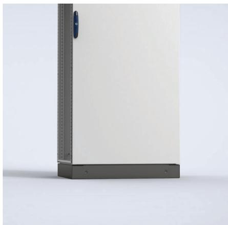
: Фронтальные и задние панели цоколя. Для кабельной проводки в соответствии со стандартом VDE 0113. Цоколь состоит из 4 угловых элементов со съемными фронтальными крышками. Боковые панели PS заказываются отдельно. Выпускаются 100 мм и 200 мм высоты. Цоколи высотой 200 мм поставляются с двумя съемными панелями высотой 100 мм. Передняя панель цельковая, высотой 200 мм. Все панели имеют двойную окантовку.
