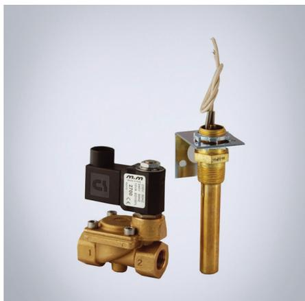
: Соленоидный клапан и термостат для ограничения подачи сжатого воздуха. Срабатывает при условии необходимости охлаждения. Заводская установка термостата 35°C, возможна регулировка температуры. Управляемый термостатом вихревой охладитель рекомендуется, если тепловая нагрузка непостоянна и ли постоянный обдув не требуется.
