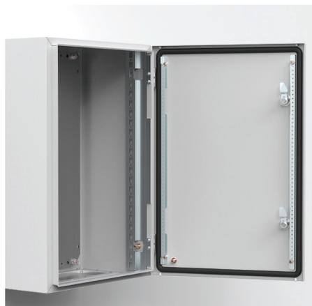
: Для монтажа поворотной рамы на полную или частичную высоту. SFBP прикреплен непосредственно к AVB. Оснащен перфорацией с шагом 25 мм. Для других вариантов монтажа можно использовать крепеж CNM. Монтируется перед креплением шарниров. Для корпусов из нержавеющей стали требуется механическая доработка.
