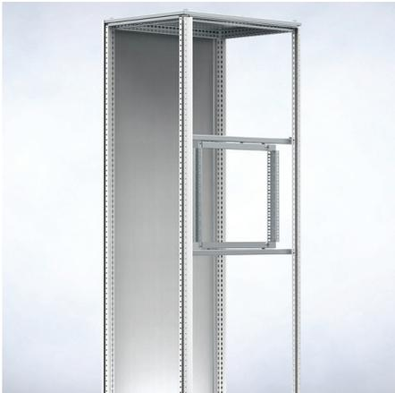
**Descrição:** Marco giratório de altura parcial para componentes de 19" com abertura à direita ou à esquerda. Pode ser instalado em armários murais e de assentamento ao solo. Marco com perfil rígido em S com padrão perfurado de 19" na frente e atrás. Marco zincado para ligação directa à terra das componentes instaladas. Ângulo de abertura standard de 125°-155°. A montagem em armário de parede requer o suporte transversal SFBP em combinação com AVB.
