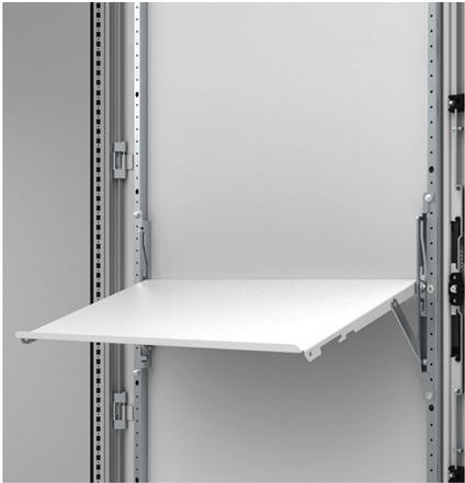
**Descrição:** Montado directamente sobre o perfil de reforço da porta, proporciona uma superfície estável para esquemas, documentação, computador ou aparelhos de medida. O estirador é abatível e fixada no interior do perfil de reforço da porta. Oferece um sistema de posicionamento automático em ângulos de 55°, 70° e 90°. A estirador DDK800R5 pode ser montado em portas com 1000 mm de largura utilizando o acessório DCP1002.
