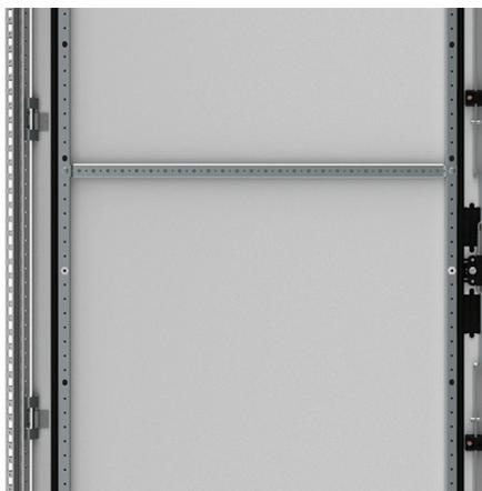
**Descrição:** Perfis para montagem horizontal com furos de 25 mm. São fixadas directamente ao perfil de reforço da porta. Para uma fácil montagem de equipamento leve, utilizando parafusos CNT05, furos padrão de 4,5 mm e 6,5 mm de diâmetro.
