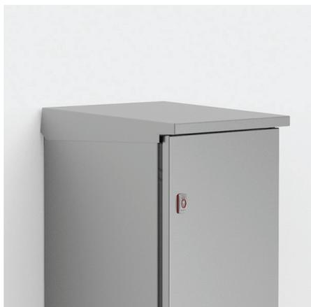
**Descrição:** A ser instalado num invólucro outdoor em aço inoxidável (ao ar livre) montado na parede. O tejadilho é ligeiramente inclinado e tem uma "caleira" de gotejamento. Usinagem é necessária. As dimensões do invólucro vai ser aumentada em A: 60 mm, P: 20 mm e L: 20 mm.
