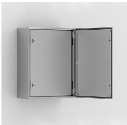
**Descrição:** Para controladores, contadores, indicadores luminosos, etc. As dobradiças podem ser montadas de forma a permitir a abertura à esquerda ou à direita. Fechadura com canhão DIN 3 mm, as portas com altura superior a 800 mm levam 2 fechaduras. Profundidade útil entre a porta interior e a exterior: 35 mm, profundidade ajustável com o acessório AMG. Área de montagem: A-55, L-108. Versão de 19" sob consulta.
