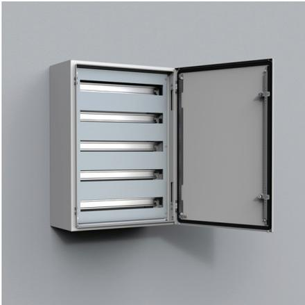
**Descrição:** Usado para fácil montagem de componentes de calha DIN com uma altura máxima de 68 mm. Distância entre as calhas 125 mm. Se necessário, a porta do armário standard pode ser substituída por uma porta de vidro. Profundidade utilizável entre tampa frontal e externo porta: 35 milímetros. Em armário de aço inoxidável é necessário mecanização.
