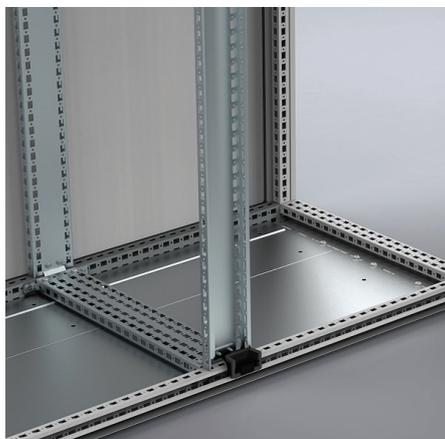
**Description:** Placée au milieu d'une armoire de 1 200 ou 1 600 mm de largeur (en haut et en bas), elle offre des possibilités de montage standard en deux sections de 600 ou 800 mm de large. Ceci permet de répartir les équipements (CAB(P), CBU, CLPK, CLPF, etc.) des deux côtés de l'armoire. Accessoires réglables en profondeur grâce aux perforations au pas de 25 mm.
