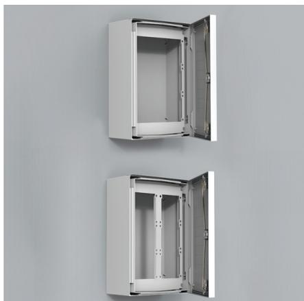
**Description:** Cadre à recouvrir de plaques d'obturation UICP. Pour armoires de 600 et 800 mm de large avec 2 colonnes. Écart entre l'UFCP et la porte de l'armoire : 39 mm ; 49 mm à partir du modèle UCP750. Position de montage réversible pour augmenter l'écart entre l'UFCP et la porte de l'armoire de 30 mm.
