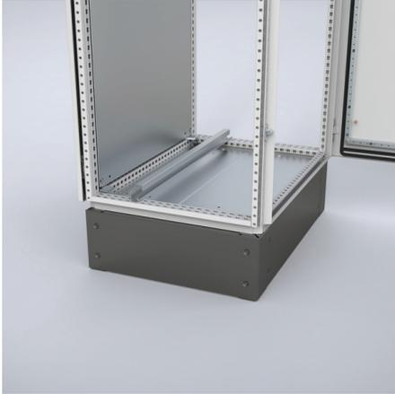
**Description:** Montés au-dessus des plaques de fond. Sert de supportage aux serre-câbles CAC pour la fixation des câbles. positionnement ajustable en profondeur. Lorsque des câbles blindés sont raccordés au support, cela contribue à compléter la cage de Faraday pour une protection CEM maximale.
