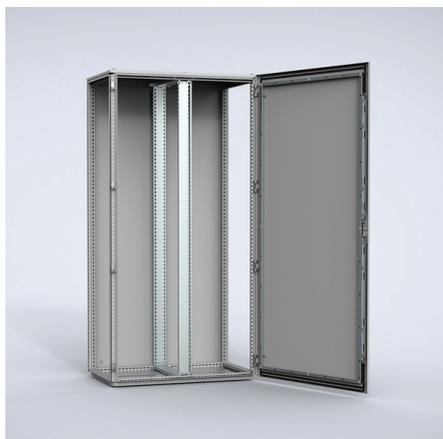
**Descripción:** Montado en el centro de armarios de 1200 mm o 1600 mm (frontal y posterior) para facilitar la división en dos secciones verticales de 600 mm o 800 mm de ancho. Esto permite montar accesorios tales como marcos giratorios o el sistema de perfiles en cada sección del armario.
