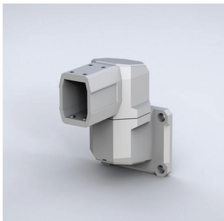
**Descripción:** Unión a pared con salida horizontal para sistema SL, ángulo de rotación de 300° con tope. El limitador de ángulos de rotación se solicita por separado. Acceso de cables con tapa de plástico de fijación rápida.
