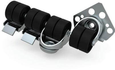
**Descripción:** Para facilitar el transporte de un armario (equipado). Puede instalarse directamente en la estructura del armario o debajo de los zócalos (PF/PV) con los soportes de montaje suministrados. Eleva el armario 70 mm.
