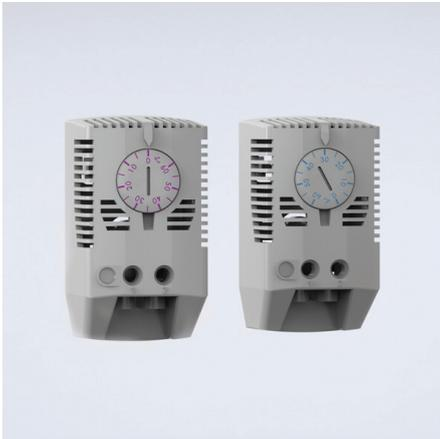
**Descripción:** Termostato con contacto de NC/NA para controlar la temperatura del cuadro. ETR202 con contacto normalmente cerrado para la regulación de calefacciones. ETR201 con contacto normalmente abierto para el control de ventiladores, intercambiadores de calor o señalización. Sensor bimetálico termostático. Montaje rápido sobre carril DIN 35 mm (EN 60715).
