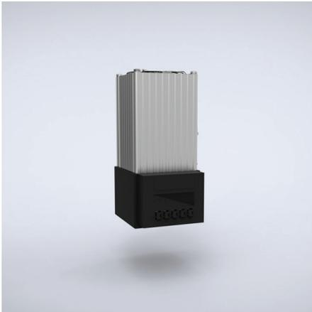
**Descripción:** Resistencia con ventilador para fijarla preferentemente en posición vertical y prevenir la condensación. El ventilador refuerza la convección natural para la distribución rápida del calor en armarios grandes. Montaje rápido en carril DIN de 35 mm (EN60715).
