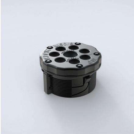
**Descripción:** Tapa de entrada de cables de plástico redonda para introducir cables y/o conductos neumáticos de una forma rápida, económica y sin herramientas. Sellado integrado. Para montaje a presión y fijado con una tuerca de cierre. El sistema a presión funciona para paredes de espesor de 1,4 a 2 mm. Altura de instalación: 9 mm exterior y 24-25 interior.
