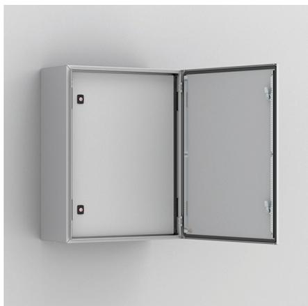
**Descripción:** Para controladores, aparatos de medida, luminarias, etc. Se pueden instalar bisagras para permitir la apertura a derecha o izquierda. Cierre DIN 3 mm. Las puertas con altura de 700 mm y superiores llevan 2 cierres. Profundidad útil entre la puerta interior y exterior: 35 mm. Ajustable en profundidad con el accesorio AMG. Área de montaje: A-55, An-108. Versión en 19" disponible bajo pedido. En armarios de acero inoxidable se requiere mecanizado.
