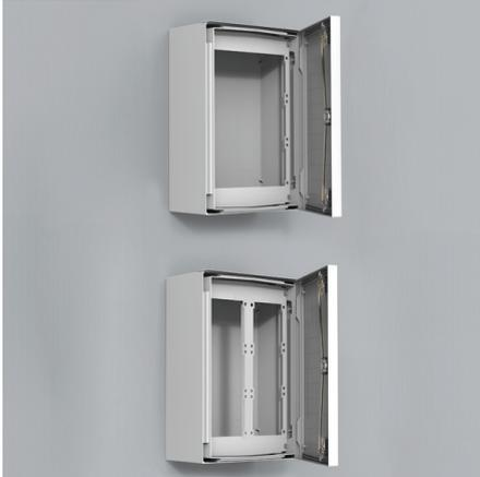
**Beschreibung:** Rahmen, mit einzelnen Abdeckplatten UICP abzudecken Für Schränke mit 600 und 800 mm Breite verfügt er über 2 Säulen. Abstand zwischen UFCP und Schranktür: 39 mm; 49 mm für UCP750 und höher Umkehrbare Montageposition, um den Abstand zwischen UFCP und Schranktür um 30 mm zu vergrößern.
