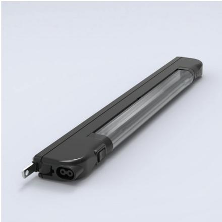
**Beschreibung:** Ihr kompaktes Design macht es möglich, sie in fast jedem Gehäuse oder Gestell zu montieren. Die Lieferung enthält drei integrierte Befestigungssysteme z. B. Magnet-, Schraub- und Einschnappmethode und mit einem Verbindungskabel. Es wird mit einer Schutzkappe, einem elektronischen Schnellstart und Dreifachstecker geliefert (ein/aus, Türschalter, dauerhaftes Licht). Eine eingebaute Buchse ermöglicht das Arbeiten mit einem Türschalter, der auf Wunsch geliefert wird.
