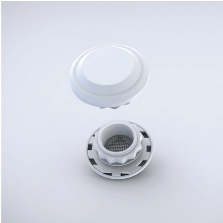
**Beschreibung:** Für optimalen Druckausgleich. Im Schaltschrank können Druckveränderungen entstehen wenn extreme Temperaturveränderungen stattfinden. Dann entsteht das Risiko von Staub oder Luftfeuchtigkeit im Schaltschrank. Montage: PG 29-Gewindebohrung mit Mutter. Für einen optimalen Druckausgleich empfehlen wir den Einsatz von 2 Ausgleichstopfen an gegenüberliegenden Seiten im oberen Schrankbereich. Dichtungsgummi NBR.
