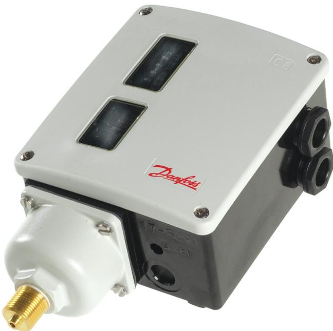
I pressostati RT sono dotati di un interruttore a commutazione unipolare a pressione controllata in cui la posizione del contatto dipende dalla pressione nella porta di connessione e dal valore impostato.
