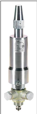
La CVC es una válvula piloto de presión constante (a un punto de referencia externo) apta para una presión máxima de trabajo (MWP) de 52 bar (754 psig) con 2 rangos de ajuste comprendidos entre -0,66 y 28 bar (19,5 pulg. Hg y 406 psig). El piloto CVC está diseñado para mantener constante la presión a un punto de referencia externo en el sistema.
