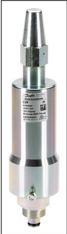
La CVP es una válvula piloto de presión constante apta para una presión máxima de trabajo (MWP) de 52 bar (754 psig) con 3 rangos de ajuste comprendidos entre -0,66 y 52 bar (19,5 pulg. Hg a 754 psig). Esta válvula piloto se usa para mantener constante la presión en el lado de entrada de la válvula principal.
