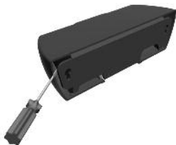
Apertura de la unidad no instalada
