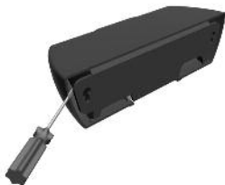
Apertura dell'unità quando non installata
