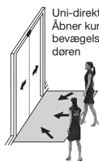
Uni-direktional - Døre forbliver lukket ved trafik på tværs
