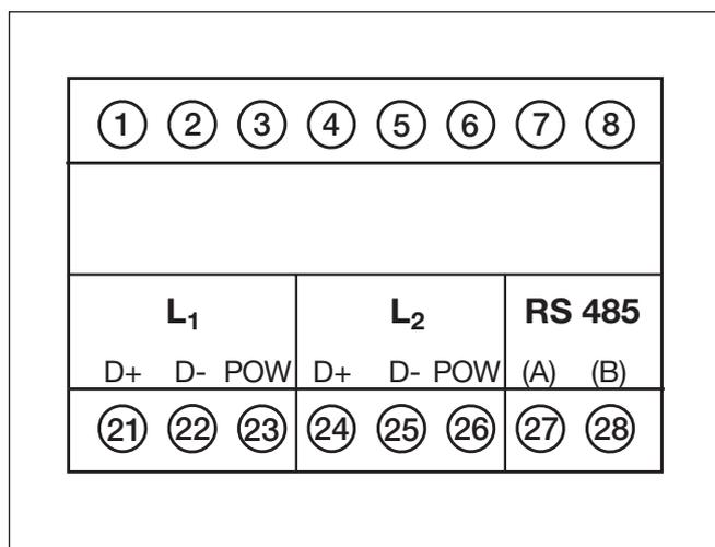
Utilizar tres cables de un hilo de 1,5 mm<sup>2</sup> para los buses L<sub>1</sub> y L<sub>2</sub>.
