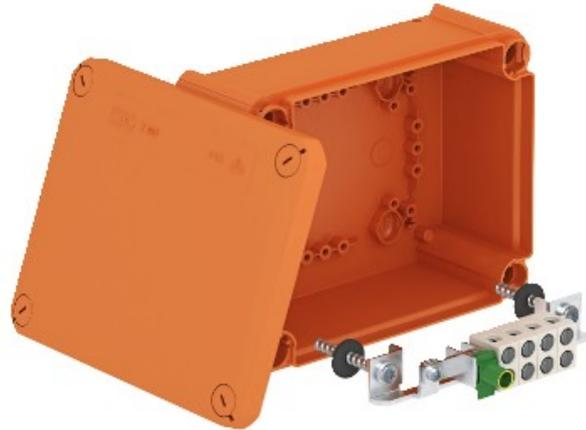
Senza alogeni, scatola di giunzione, ha approvato per la funzione elettrica di manutenzione secondo la norma DIN 4102, Parte 12. Funzione di classi di mantenimento E30 per E90.
